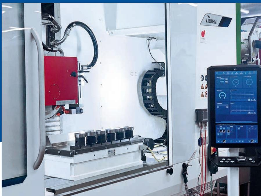
C.O.R.E. タッチディスプレイ搭載のPLANOMAT XT 408によるモジュラー式精密ツールホルダーの製造
