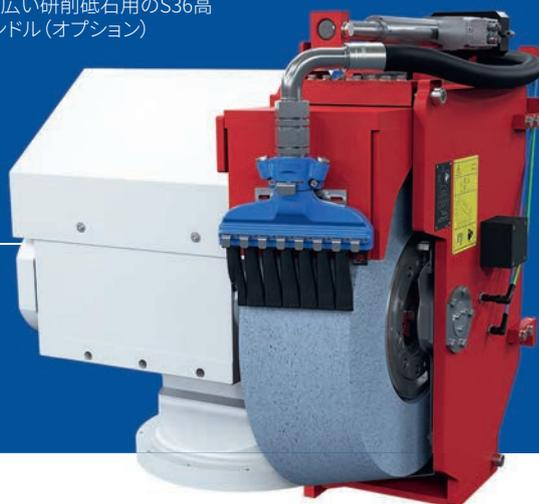
外径円筒研削盤S36のオプションとして、最大25 kWの出力を持つより強力なスピンドルが登場しました。幅広の砥石(直径610 mm、幅160 mm)と組み合わせることで、一回の研削で最大160 mm幅のワークのプランジ研削を可能にします。「これにより、そのような部品を非常に効率的に研削することが可能になりました」と、販売マネージャーのMartin Hofmann氏は説明します。
