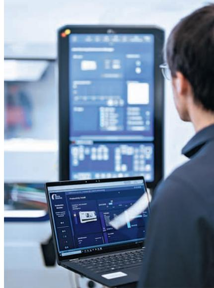
C.O.R.E.を搭載した機械は、最先端のタッチディスプレイを備え、umatiのおかげでサードパーティシステムとの通信も可能です
