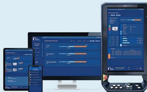
Production Monitorは、ネットワークに接続されたマシンの稼働率やステータスを管理し、UA4MTもサポートするようになりました。これにより、サードパーティ製マシンを統合することができます
