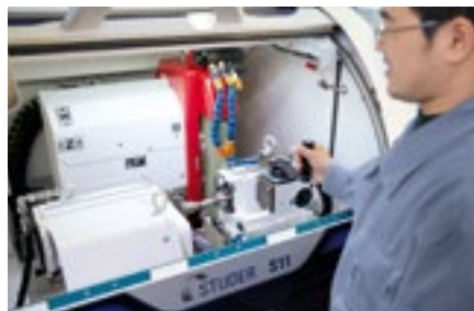
S11のリジッドテールストックのピーク圧力は、簡単かつ繊細に調整が可能です。
