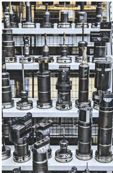
マシニングセンターのツールチェンジャーは、約200本の工具の収容が可能、その他は外部マガジンを含んでいます (右の画像)
