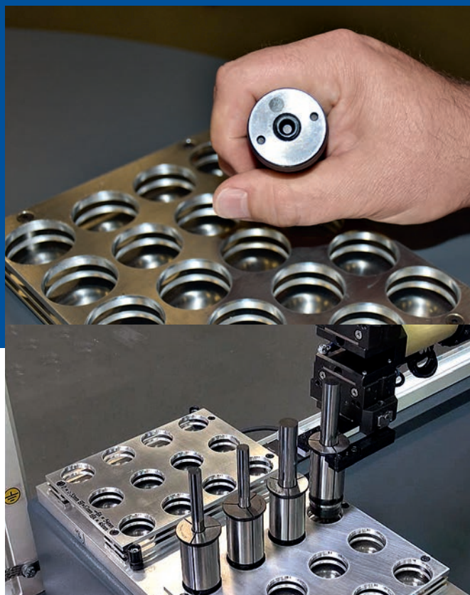
Progetto del cliente: pinza di serraggio (tipo NK) con sistema RFID per la rettifica di ripassatura automatizzata in un unico lotto di utensili di diverso diametro
