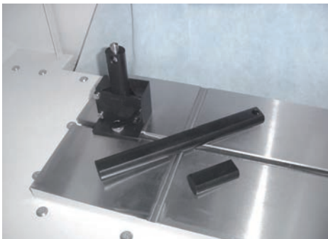
Diamanthalter mit Wechseleinsätzen (90, 150, 300 mm) für effizientes Umfangs- und Seitenabrichten sowie Kalibrieren.
