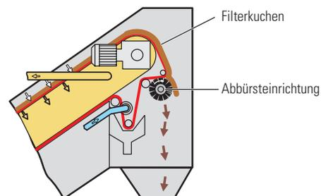
Filtervlies mit Aufwickelvorrichtung
