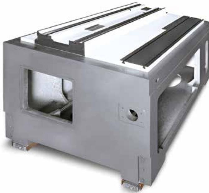
Il basamento macchina in ghisa grigia è fuso in un'unica soluzione e costituisce il fondamento della struttura della tavola ortogonale ad alta precisione nonché del blocco di attacco dei mandrini portamola. Il supporto delle guide per l'asse X è integrato direttamente nel basamento macchina. La superficie restante sulla parte superiore del basamento macchina riconduce il refrigerante tramite una vasca attorno al basamento nella vasca di lubrorefrigerante.
