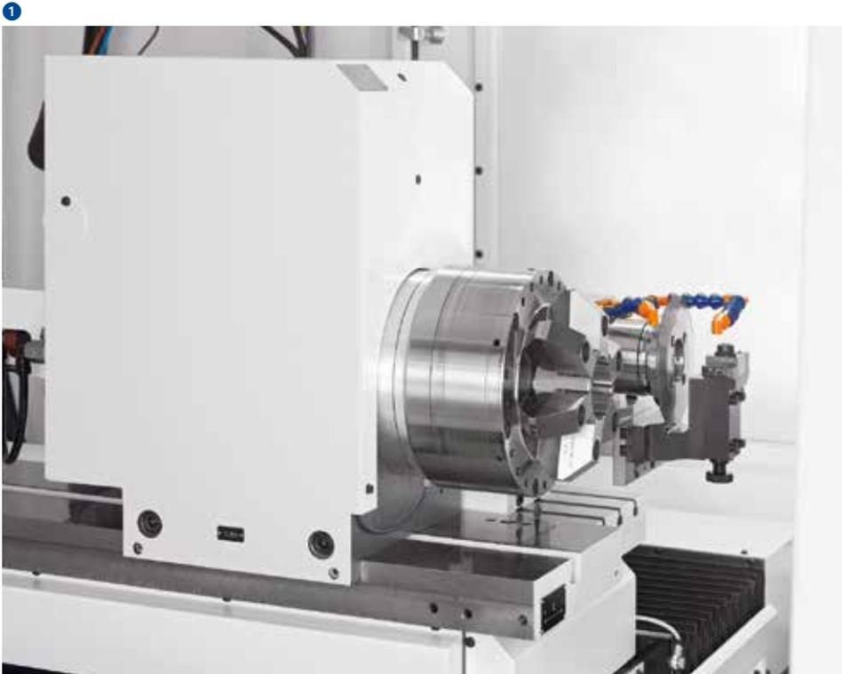
La testa portapezzo ad alta precisione è dotata di speciali cuscinetti e garantita per la massima precisione di rotazione concentrica. La testa del mandrino è conforme alla normativa DIN/ISO 702-1.
