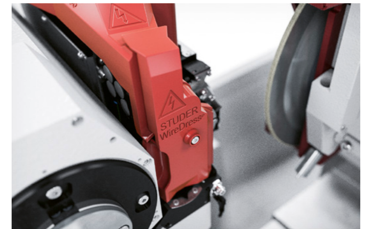
WireDress® 研削盤上でのメタルボンド砥石のドレッシングを最高精度で実現します。ワイヤードレスでは、ワイヤー放電加工の基本原理を応用し、砥粒をより突出させ、複雑な形状でも最高の寸法安定性を達成します。
