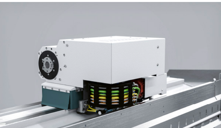
同期式心押台 同期式心押台は、長さ違いの同じようなワークを研削する場合、ワークの全体幅を研削する必要がある場合、駆動金具が使用できない場合には特に経済的な方法です。
